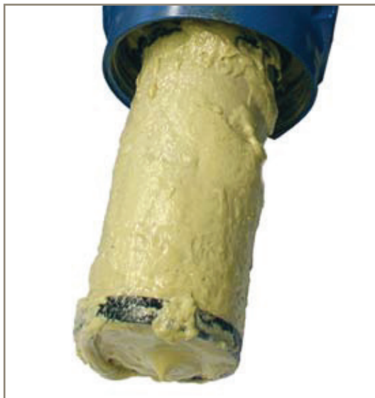
Typische Verschmutzung, die von einem TFGE / TFHE Druckluftfilter in Bahnindustriequalität zurückgehalten werden
