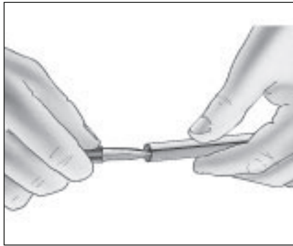
Entgraten des Kupferrohres
