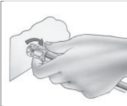
Überwurfmutter handfest anziehen
