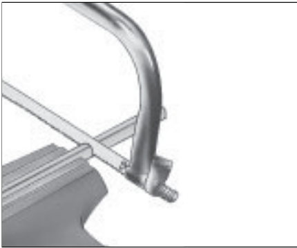
Rohr rechtwinklig abschneiden
