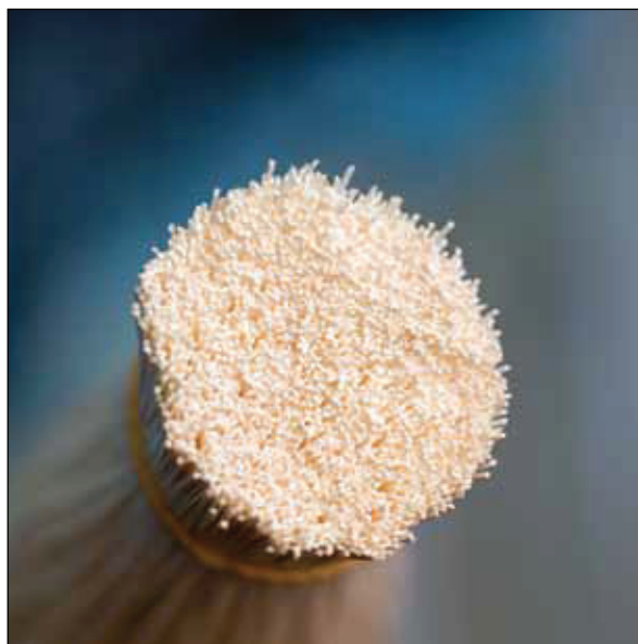
Bündel aus Hohlfasermembranen
